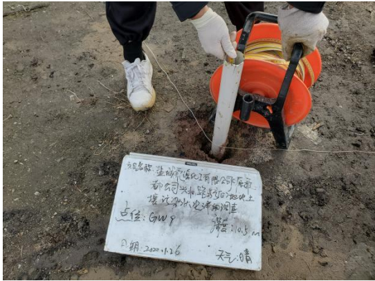
h、地下水位测量
